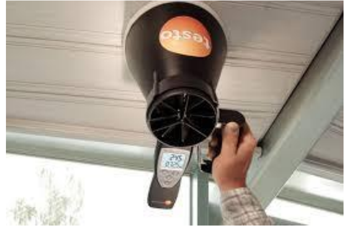
Anémomètre pour contrôle de débit sur les VMC (coût ~500€)
